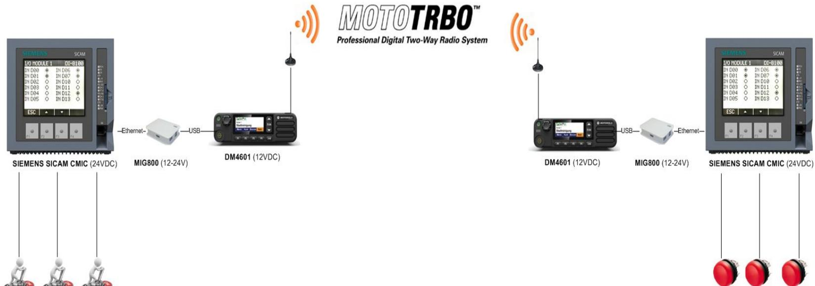
**Anschluss erfolgt über Ethernet
