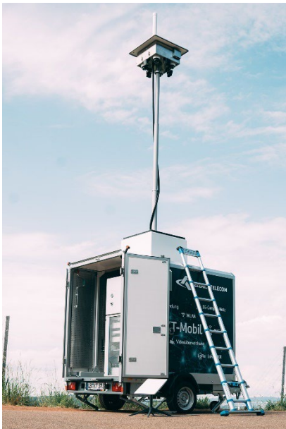
Bild: Das ConneKT-Mobil der Kellner Telecom GmbH. Der neue, flexible und mobile 5G-Campus-Anhänger.
